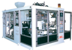
Sterownik Beckhoffa, zawory Yuken, inwertorowe napędy ślimaków z ABB
